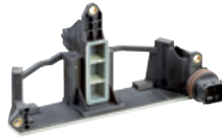
DCT变速箱传感器模块 (换挡叉位置, 齿轮速度和温度)
